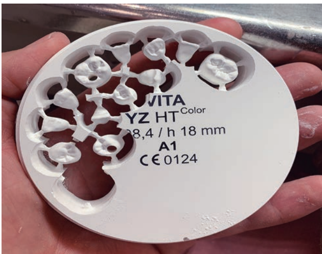
Fig. 2: Las restauraciones fresadas en la pieza en bruto, inmediatamente después de la fabricación asistida por ordenador.
